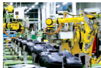
柏原工場 樹脂製燃料タンク生産ライン
