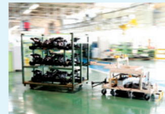
工場内で製品を搬送する自動搬送装置
